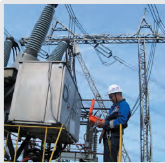
Измерение переходного сопротивления контактных соединений элегазового выключателя ALSTOM HGF-1012, 110кВ.
