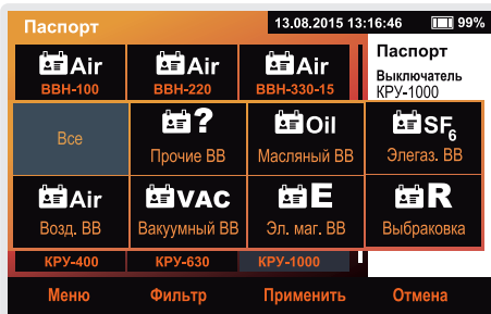
Встроенный архив паспортных значений электрического сопротивления главной цепи высоковольтных выключателей.
