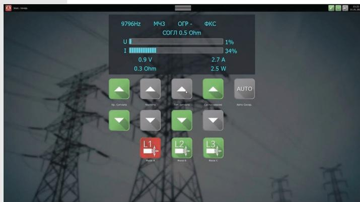
Генератор звуковой частоты мощностью 500 Вт позволяет выбрать три частоты в диапазоне от 400 Гц до 10 кГц.
