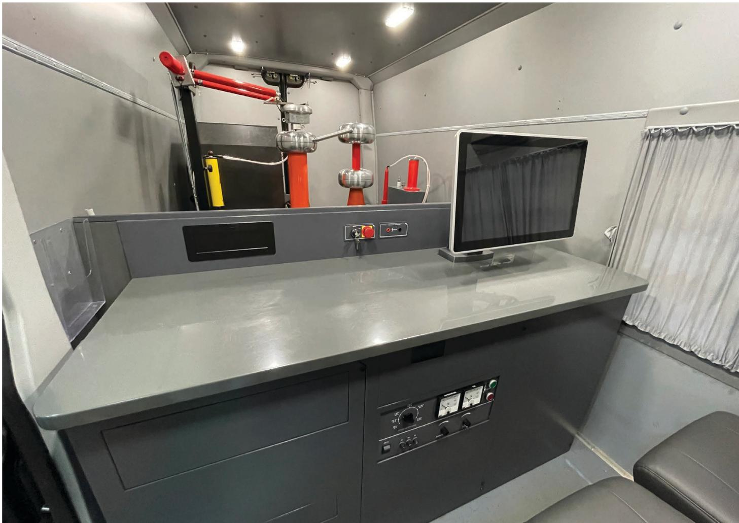
**ООО «СЕБА ИНЖИНИРИНГ»** представляет уникальную автоматизированную электротехническую лабораторию (ЭТЛ) АЛЬФА, предназначенную для испытания и поиска мест повреждений подземных кабельных линий классов напряжений 6-35 кВ с любым типом изоляции.
