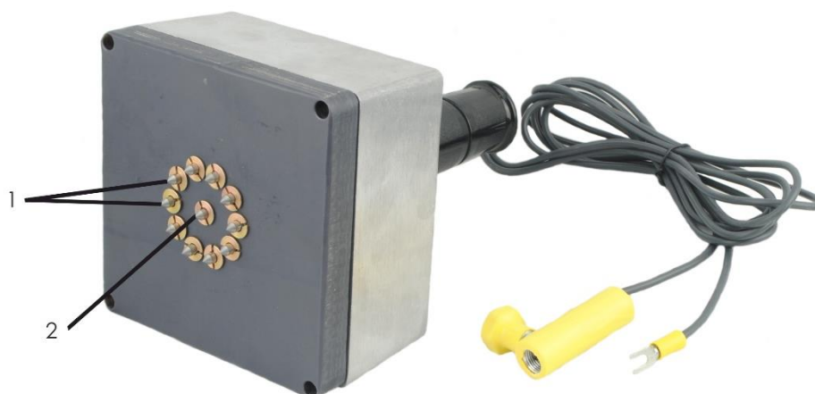
Рис. 5. Датчик для определения УЭС цилиндрических ниппелей
