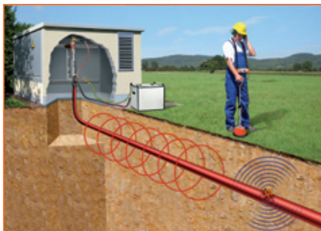
Локализация повреждения с помощью SWG u digIPHONE+
