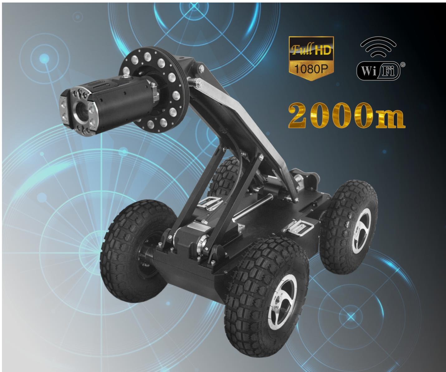
**TVS-3600** — это интеллектуальная сетевая система инспекции трубопроводов с использованием HD-камеры, простая в эксплуатации и имеющая модульную конструкцию. Она предназначена для обследования труб диаметром DN 800–1500 мм, длина кабеля до 2000 м.
