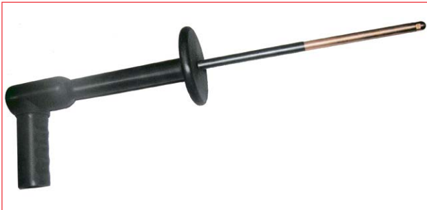
Сильноточный зонд HSP2000 – прибор, который обеспечивает возможность испытания автоматических выключателей (MCCB) без их снятия/демонтажа. Эти выключатели могут быть, например, установлены на электростанциях и в промышленности. Эти выключатели работают в диапазоне токов размыкания от 16 А до 2000 А.
