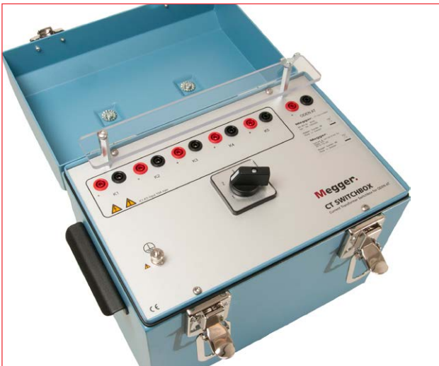
Коммутатор токовых трансформаторов для системы ODEN AT – инструмент, который используется для облегчения тестирования трансформаторов тока с помощью ODEN AT. Вторичные обмотки на токовом трансформаторе при-соединяют к входам этого коммутатора, а его выход соединяют с входом Ammeter 2 системы ODEN AT. Переключатель коммутатора используется для выбора вторичной обмотки токового трансформатора, в которой необходимо проводить измерения. Обмотки, которые не участвуют в измерении, замыкаются накоротко. Коммутатор токовых трансформаторов может оперировать с общим числом вторичных обмоток не более 5.
