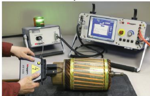
Испытание якоря при помощи приспособления ZTX и щупа коллектора ATF5000.
